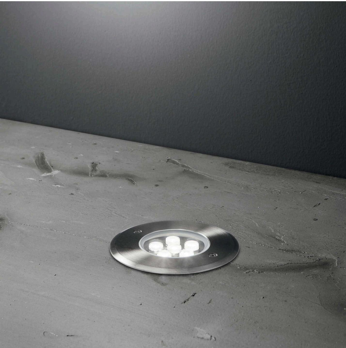
Incasso fisso da esterni in alluminio pressofuso con ghiera rotonda disponibile in tre dimensioni, adatto per installazione a terra e a pavimento. LED integrati raffreddati passivamente con ottica di 30°, CRI 80, grado di protezione IP 67, IK 10.
