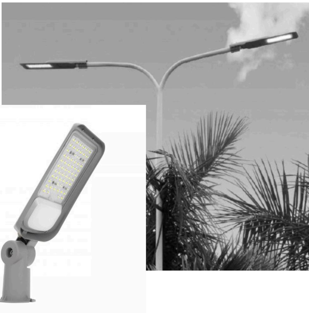
Armatura stradale LED 100W **con snodo incorporato in alluminio**, dotata di tecnologia LED ad alta luminosità. Ha un flusso luminoso di 14.500lm (efficienza 145lm/W) e un angolo di illuminazione asimmetrico di 70x140°.
